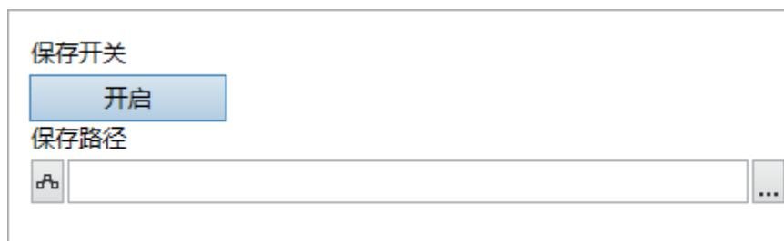
打开“主程序”软件，先别点“采集”数据，点击“保存开关”按钮，让其处于开启状态，再在界面左下方，选择保存路径，最后点击“采集”数据，等“采集”数据结束，点击“停止”采集。
