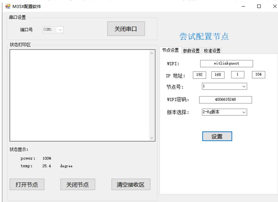
4. 点击“参数设置”按键，设置工作模式、采样率、量程等。设置完成后点击“设置”按键。
