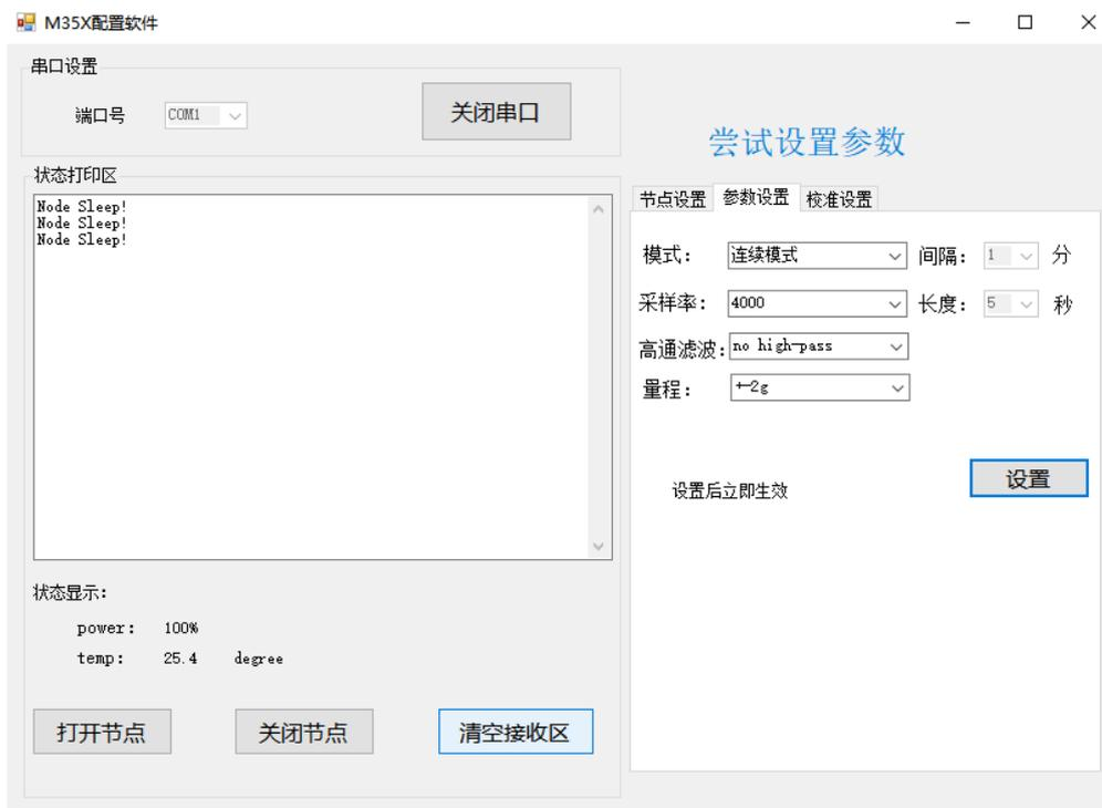
5. 开机，用磁铁靠近“充电孔”右边一下，观察传感器左边红灯亮、接着上方红灯亮、最后上方蓝灯亮。也可在配置软件看到“状态打印区”发出一帧一帧的数据，则配置成功，可拔掉数据线。
